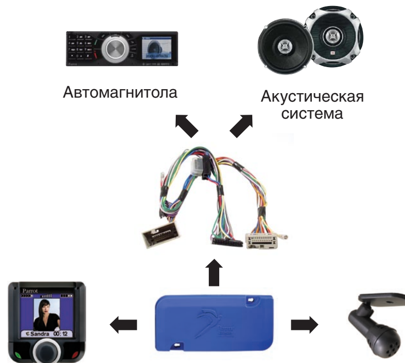
Схема подключения комплекта Parrot 3200LS-Color
