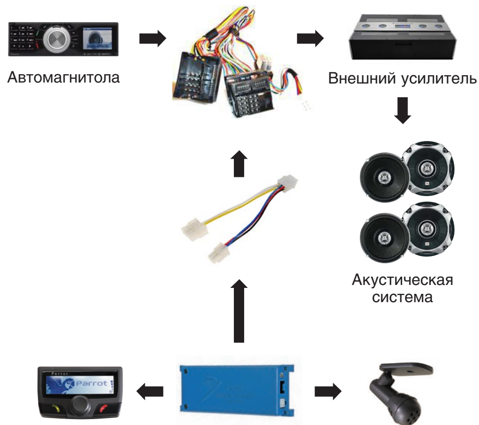
Схема подключения комплекта Parrot CK3100
