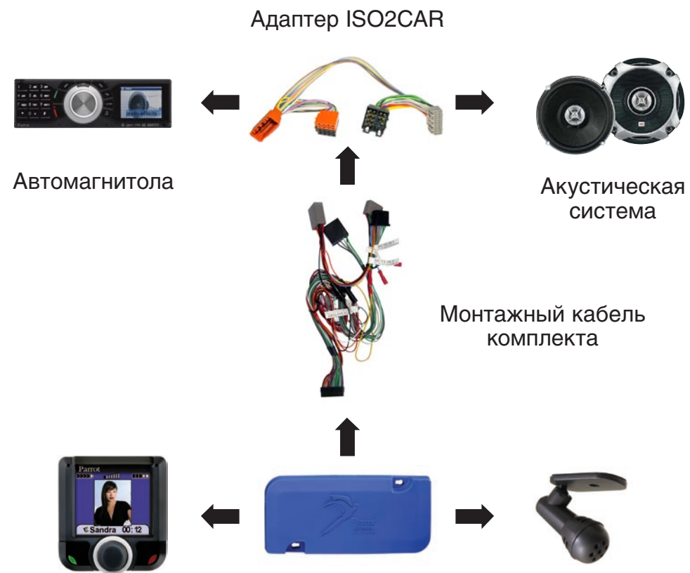
Схема подключения комплекта Parrot 3200LS-Color
