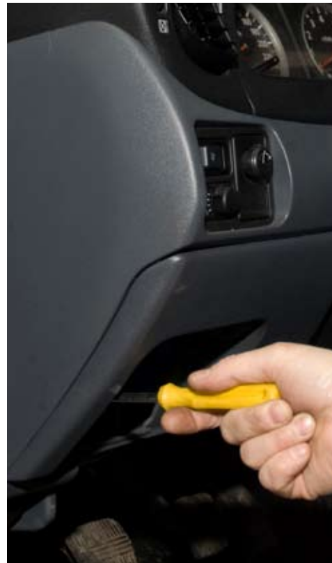
Откручиваем саморезы крепления нижнего кожуха торпедо (справа и слева от руля)
