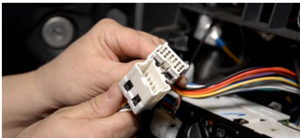
Подключаем интерфейсный кабель к штатным разъемам
