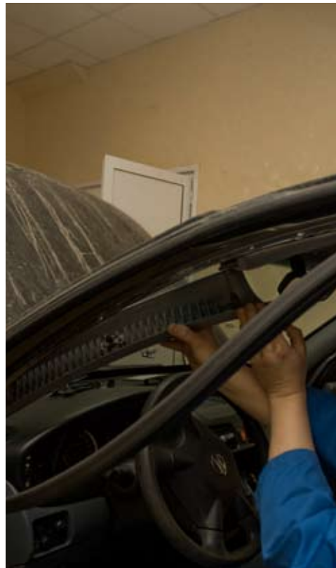
Снимаем накладку левой стойки, потянув ее на себя
