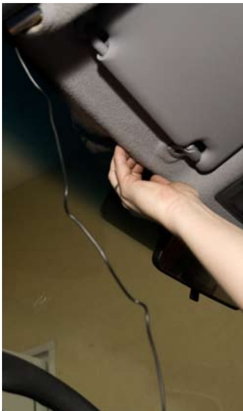
Протягиваем кабель над лобовым стеклом
