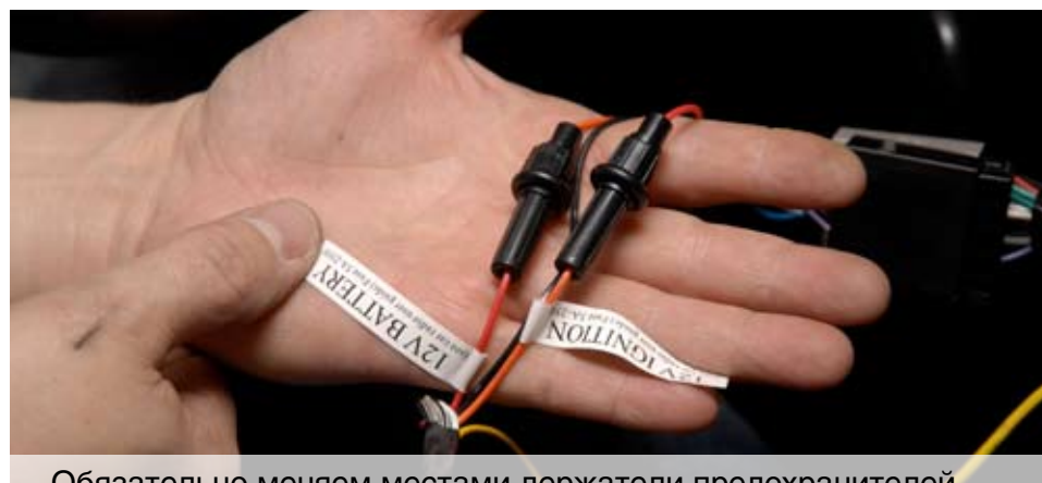
Обязательно меняем местами держатели предохранителей +12 Ignition и +12 Battery для корректной работы комплекта громкой связи
