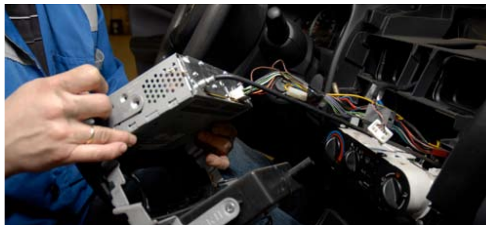
Снимаем блок управления отопителем вместе с головным устройством
