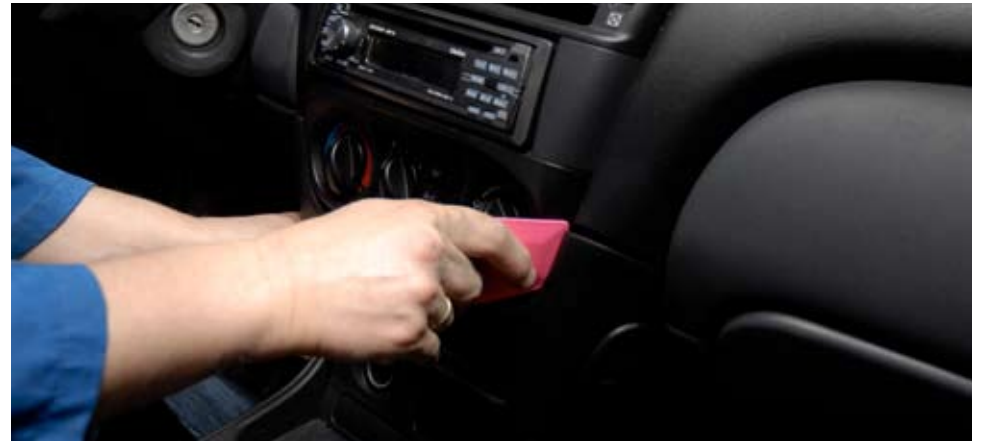
Поддеваем лопаткой нижний кожух торпедо...
