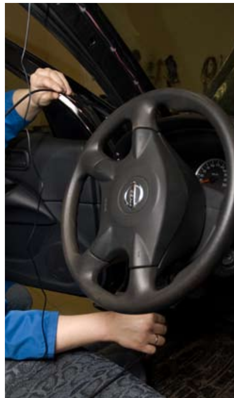
... и пропускаем его в под рулем, выводя в нишу головного устройства
