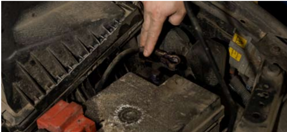
Согласно нормам техники безопасности снимаем минусовую «-» клемму с контакта аккумулятора
