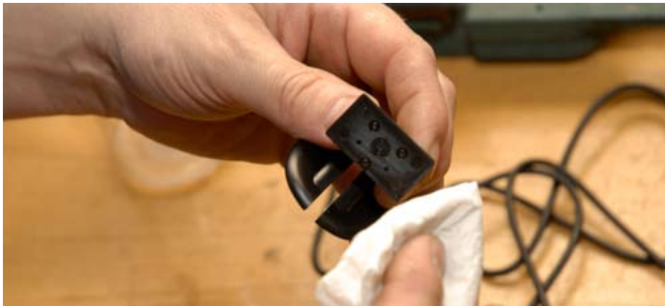
Обезжириваем склеиваемые поверхности
