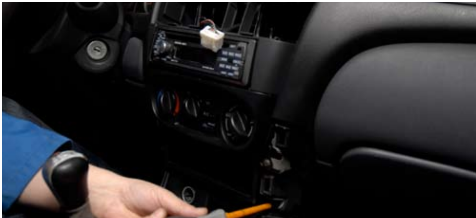
Отворачиваем четыре самореза крепления блока управления отопителем по периметру
