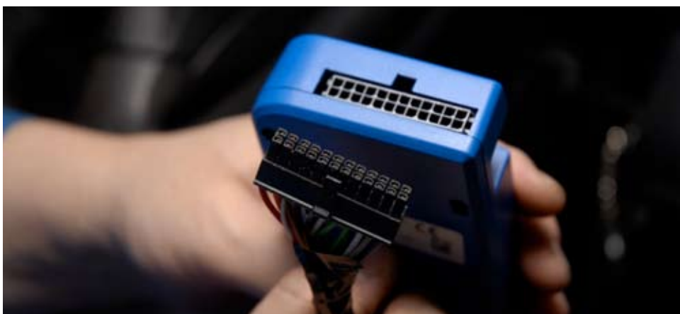
Подключаем разъем блока управления
