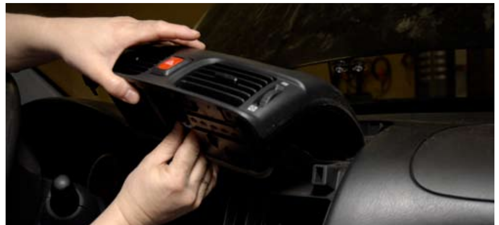
Снимаем верхний кожух, сильно потянув на себя
