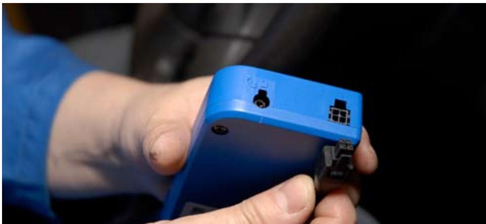
Подключаем разъем дисплея
