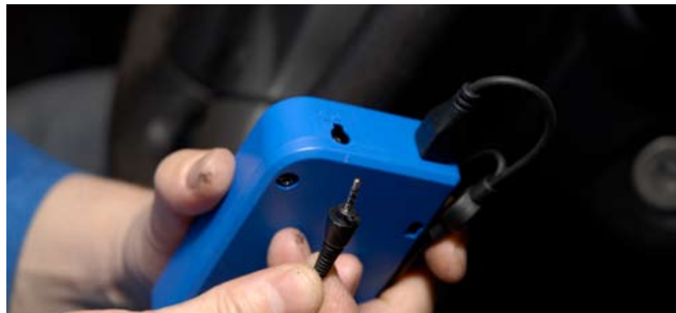
Подключаем разъем микрофона, поворачиваем его по часовой стрелке до совпадения меток
