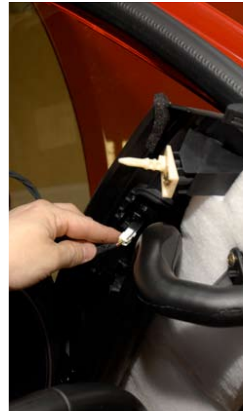
Отстегиваем от накладки разъемы и снимаем ее
