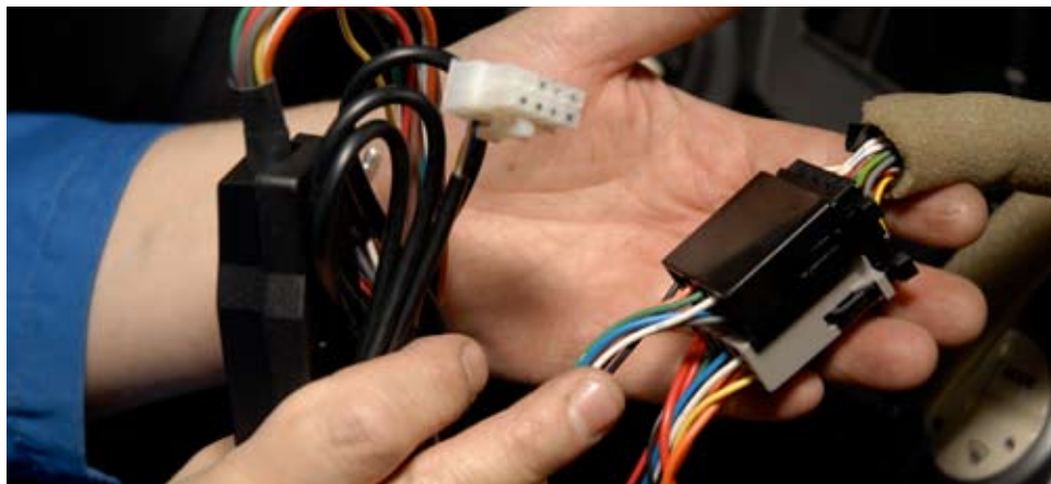
Подключаем провода комплекта Parrot к ISO-разъемам головного устройства
