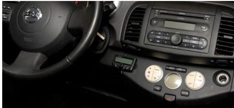
Второй вариант установки, под головным устройством
