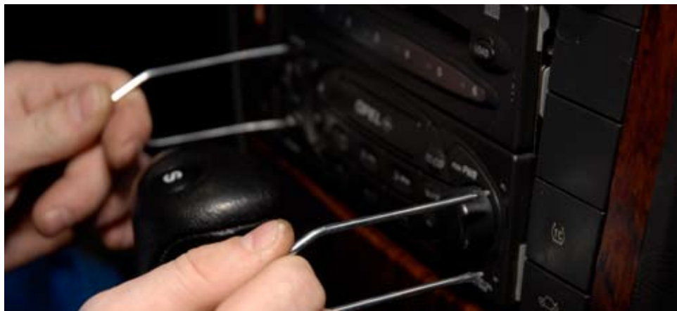
Вставляем ключи-съемники в пазы головного устройства
