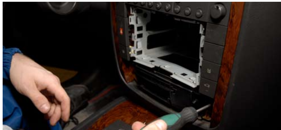
Откручиваем саморез справа...
