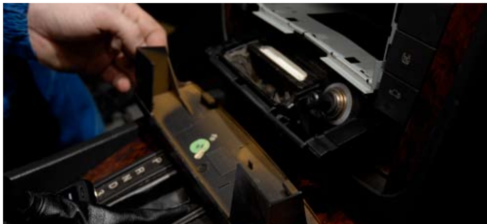
Снимаем декоративную накладку
