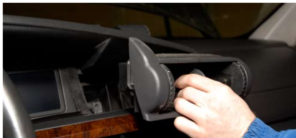
и вынимаем основание дефлекторов
