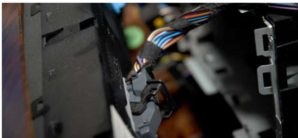
Сдвинув кожух вперед, отстегиваем два разъема
