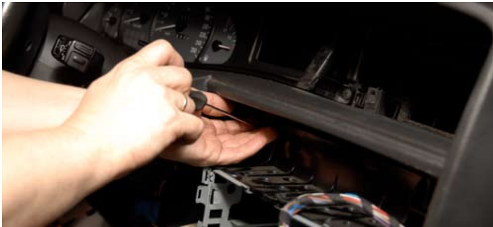
Выкручиваем два оставшихся самореза крепления корзины
