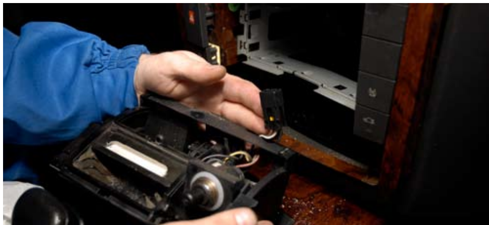
Снимаем пепельницу и отсоединяем разъем прикуривателя
