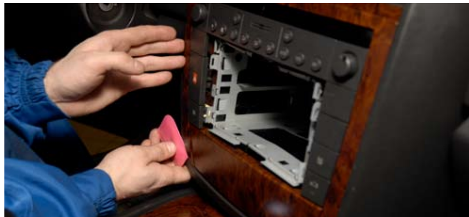
При помощи пластиковой лопатки отщелкиваем центральный кожух
