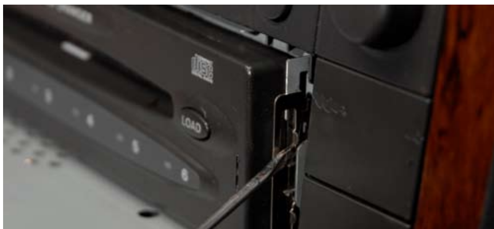
Тонкой шлицевой отверткой отжимаем фиксаторы CD-ресивера
