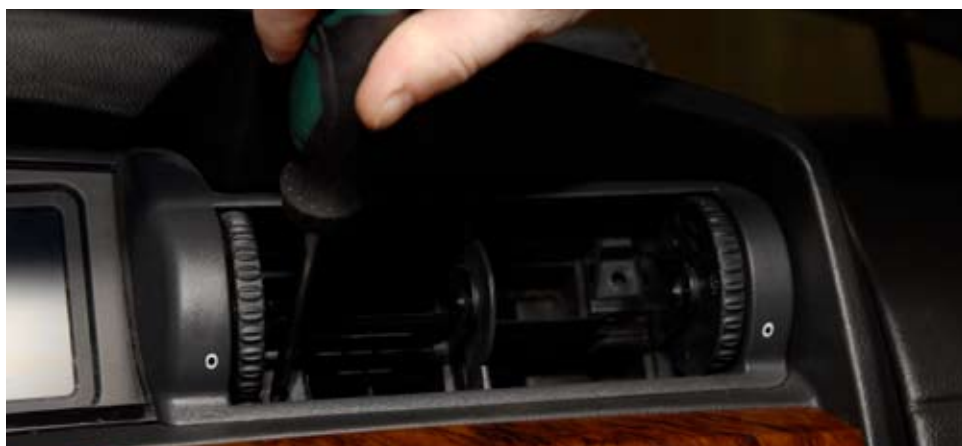
Откручиваем саморезы крепления
